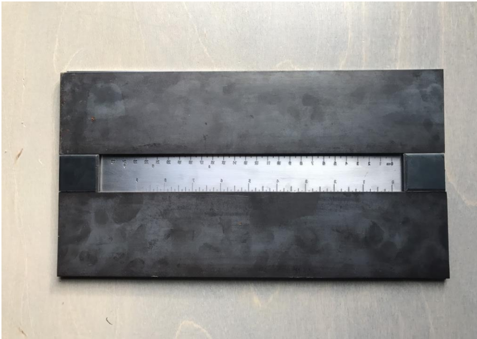
Figuur 13: De gegraveerde onderplaat met zijplaten en vierkante blokjes
