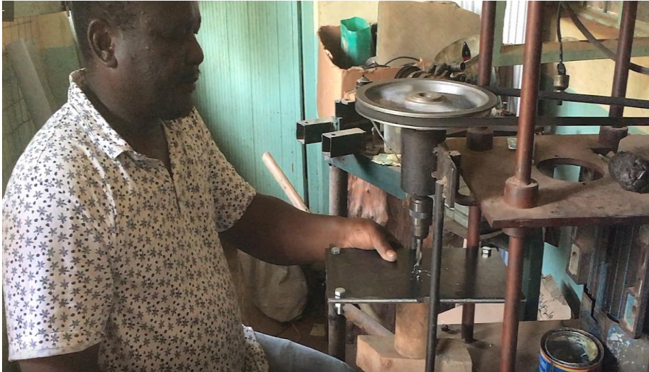
Figuur 20: Het spuitgat wordt in de mal gemaakt
