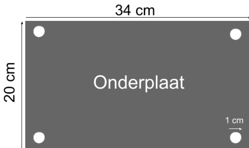
Figuur 10: De onderplaat van de mal
